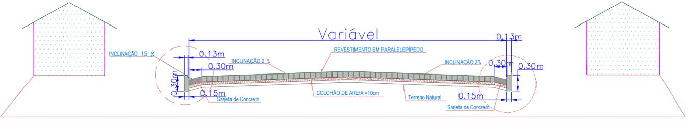
CORTE TRANSVERSAL DA PAVIMENTAÇÃO SEM CALÇADAS
